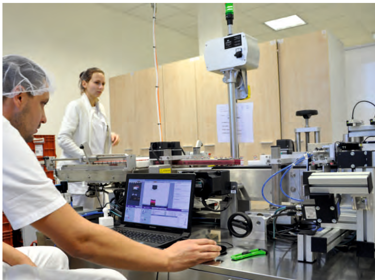
Kierownik wydziału Radek Picka przy sprawdzaniu poprawności działania systemu kamer do kontroli optycznej fiolek, z tyłu - Kamila Keňová podczas obsługi urządzenia do etykietowania.
