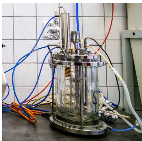
Mały bioreaktor badawczy, który umożliwia testowanie kultur antygenów przed przeniesieniem ich do masowej produkcji
