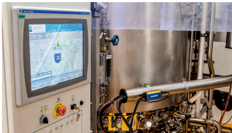
Jednostka sterująca bioreaktorami Applikon 1500 I.
